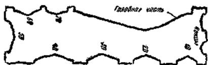
**Рис. 96. Шаблон для проверки вы-пукласти блёсны.**
